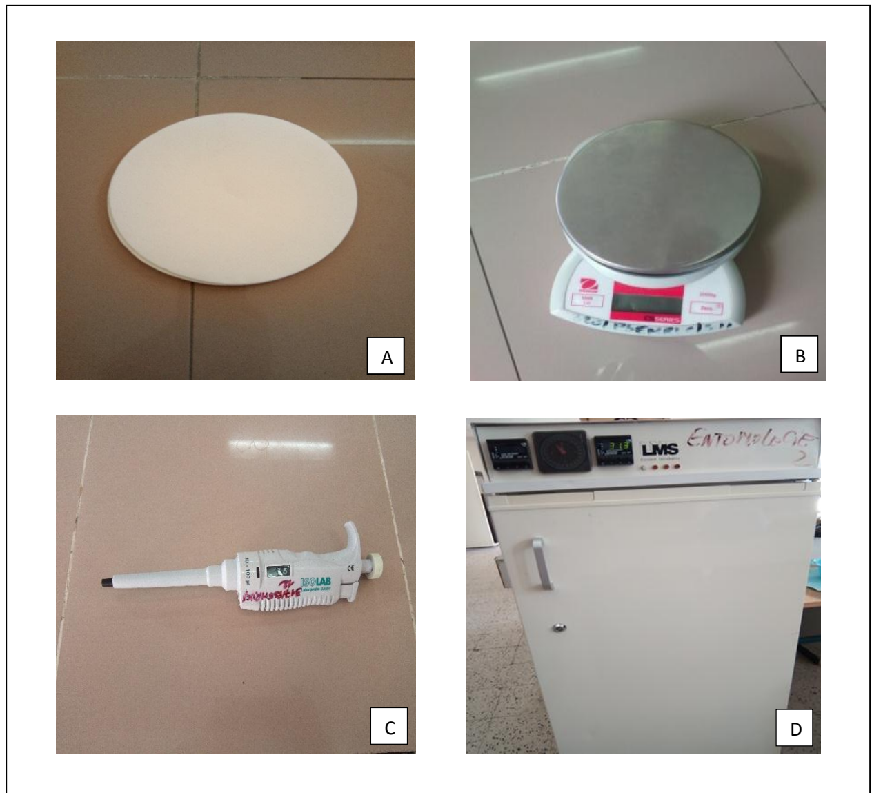
Figure 5 : Matériels de laboratoire utilisés, (ORIGINALE, 2018). (A): Papier filtre, (B) :balance électronique (C):Pipette, (D):Etuve réfrigérée.
