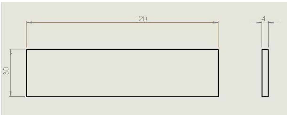
**Figure 4-3** : Dimensions de l'éprouvette utilisée
