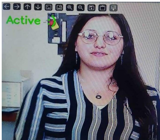
Figure III.11 : Résultat du test d'un conducteur dans l'état normal avec accessoire.
