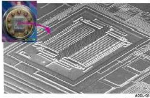
Figure 9 : Accéléromètre réalisé en usinage de surface [7]
