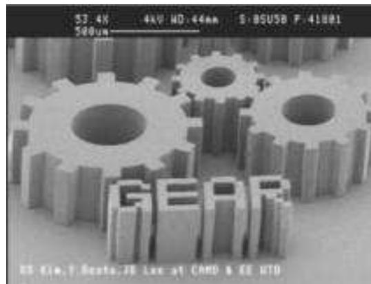
Figure 7 : Exemple de réalisation par HARSE [12]
