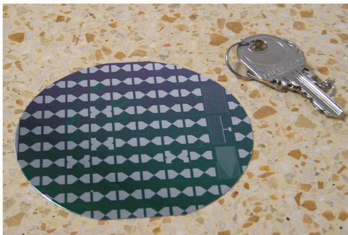
Figure 36 : Photo de la distribution des sondes sur une plaque de 4 pouces
