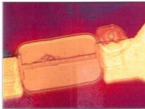
Figure 40e : Débris de résine mal gravés
