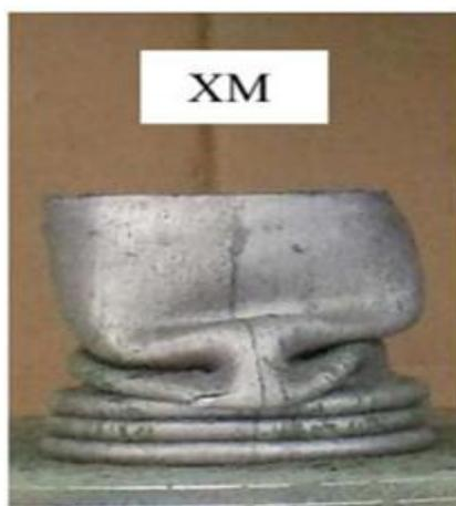
*Figure I.13:Le mode de déformation non-axisymétrique, mixte.*
