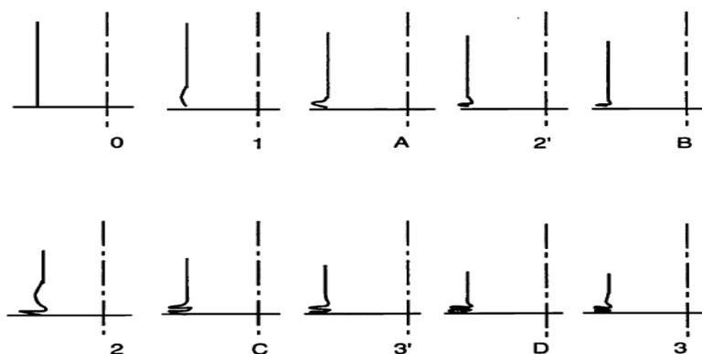
*Figure I.12: analyse du mode de déformation axisymétrique.[8]*
