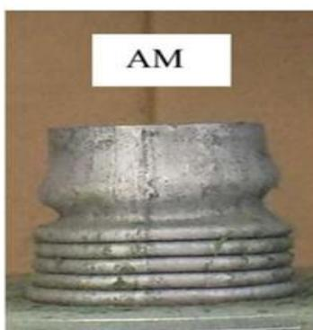
Figure I. 10: le mode d'écrasement axisymétrique.
