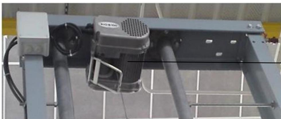
Figure : motorisation de dispositif crash-test
