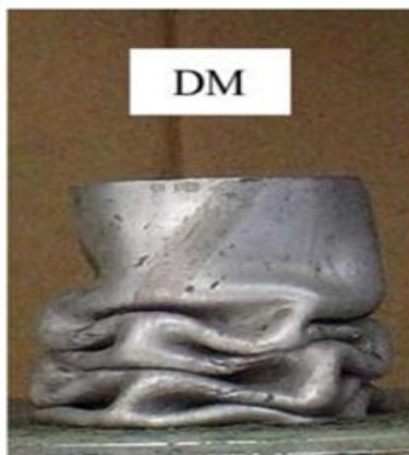
*Figure I.14: le mode de déformation non-axisymétrique en diamant.*
