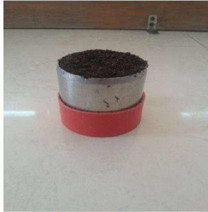
Figure 1: Cylindre pour la détermination de la densité apparente
