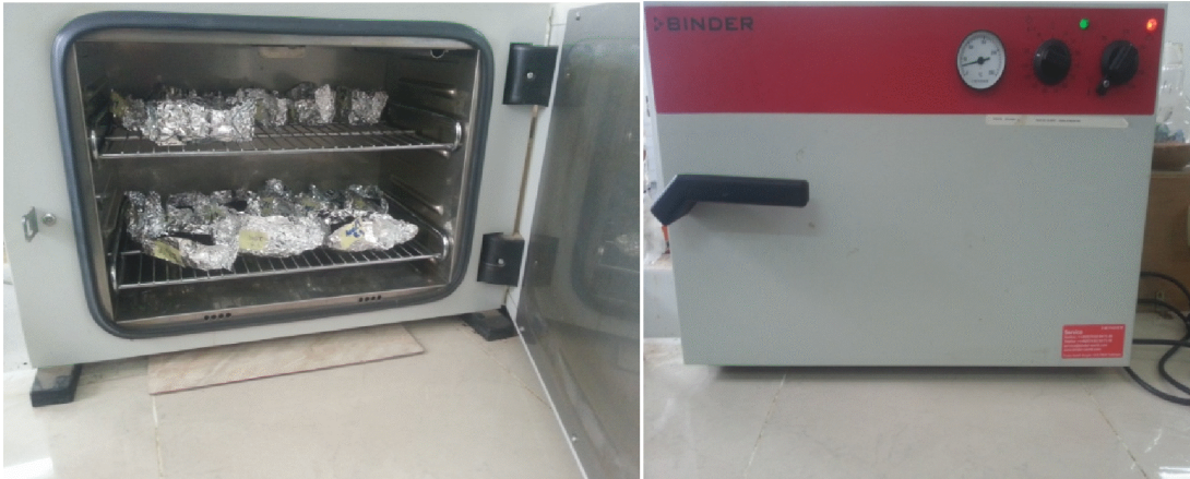
Figure 2: Détermination de la matière sèche et humidité du compost
