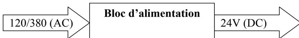
**Figure III.6 : alimentation d'un API**
