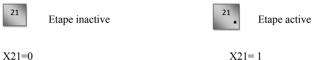
**Figure II.3 : Etape inactive et étape active**
