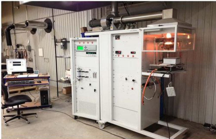
Figure 2-10 Vue générale d'un cône calorimètre
