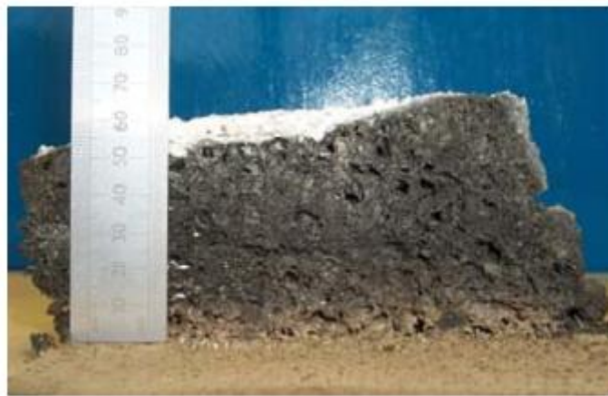
Figure 1-3 Photographies de l'échantillon avant et après l'essai au feu à gauche : avant l'essai au feu à droite : après l'essai au feu en bas : vue en coupe après l'essai au feu
