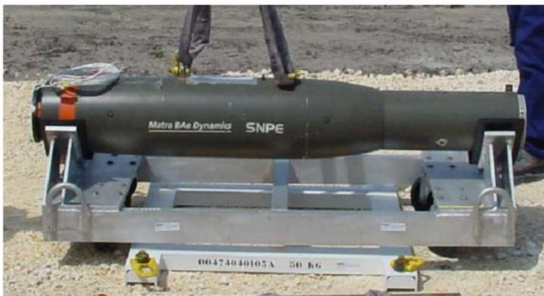
Figure 2-5 CBEMS revêtu de peintures intumescentes
