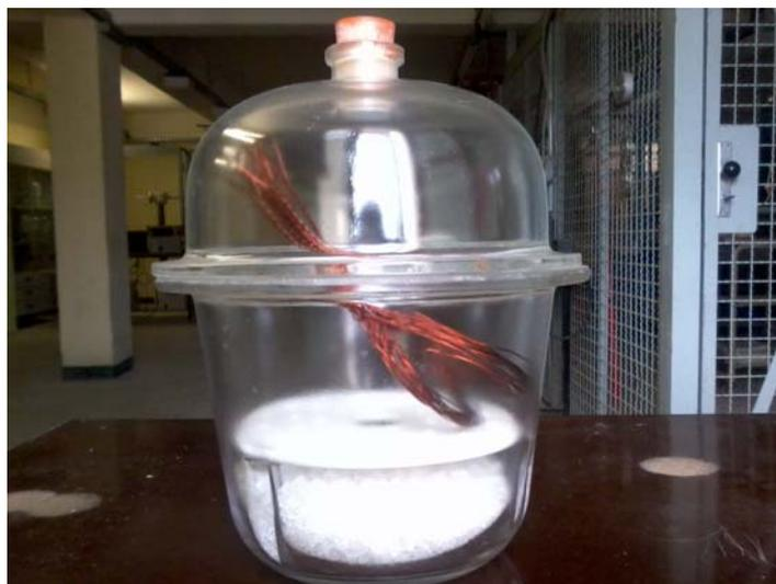
Figure IV.10. Ensemble dessiccateur et échantillons en cours de conditionnement.
