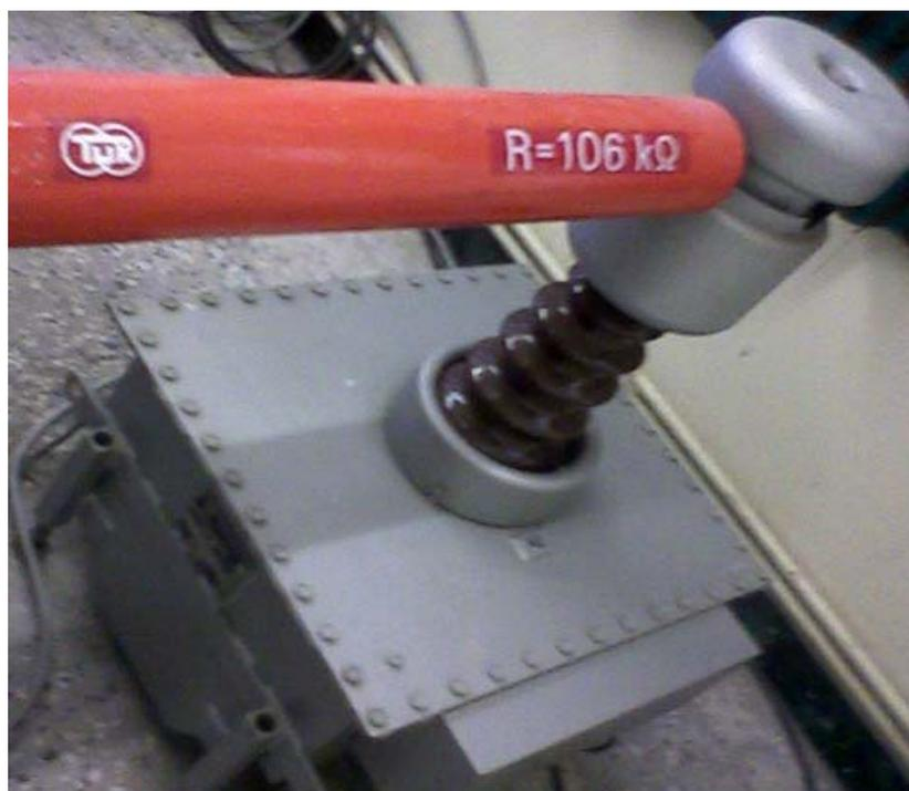
Figure IV.7. Transformateur haute tension avec une résistance d'amortissement.
