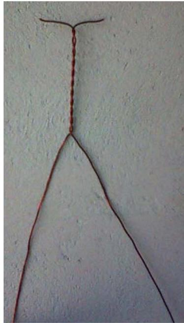
Figure IV.4. Eprouvette en forme de torsade réalisée.
