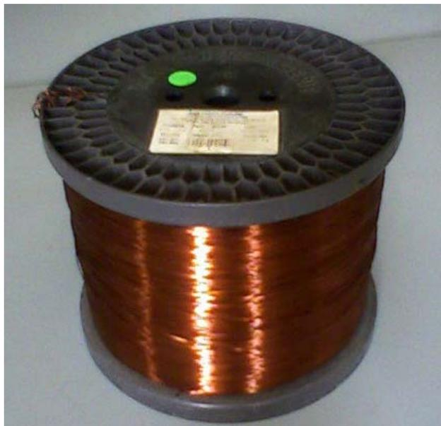
Figure IV.1. Bobine de fil de cuivre isolé au polyamide imide.
