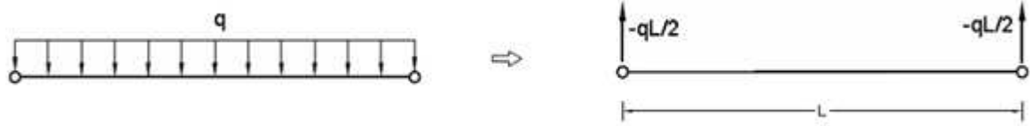
Fig. 2.11. Cas du poids propre d'une barre d'un treillis
