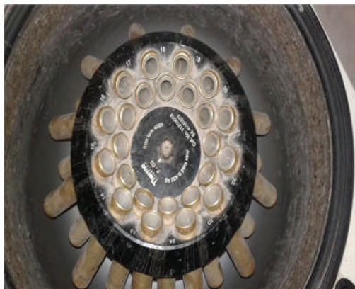
Figure 11 : La Thermo Scientific CL10 à godet circulaire à capacité de 24 tubes.
