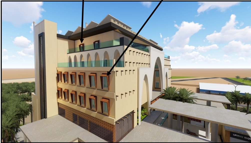
Figure182 : l'utilisation du bois composite sur la façade
