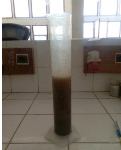
Figure III-6 : Essai de la détermination de la masse volumique absolue du sable.
