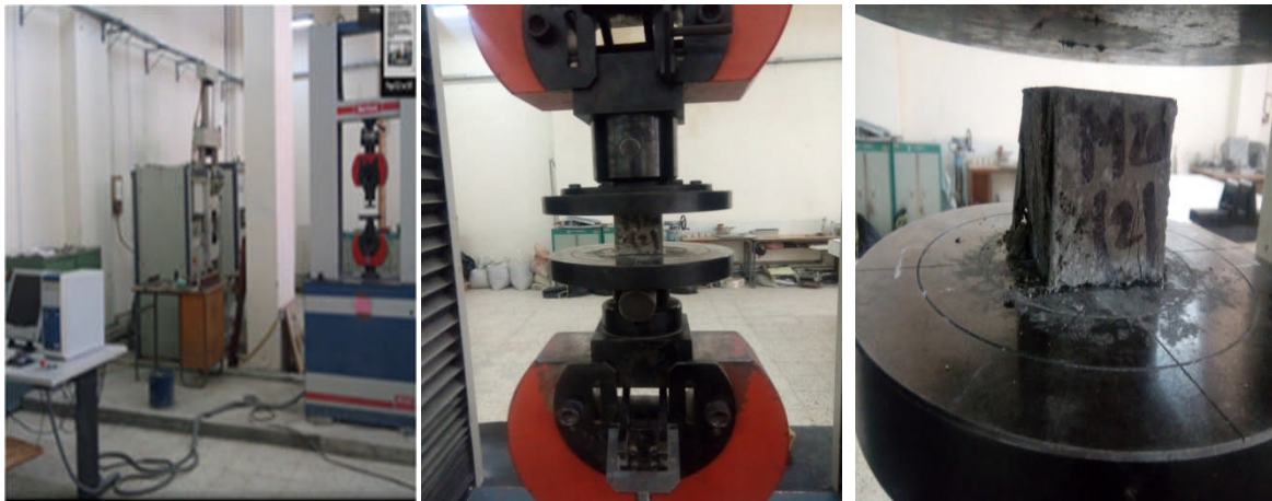
Figure III-24: (a):Presse Ibertest ; (b):éprouvette soumise en ;(c):éprouvette après rupture
