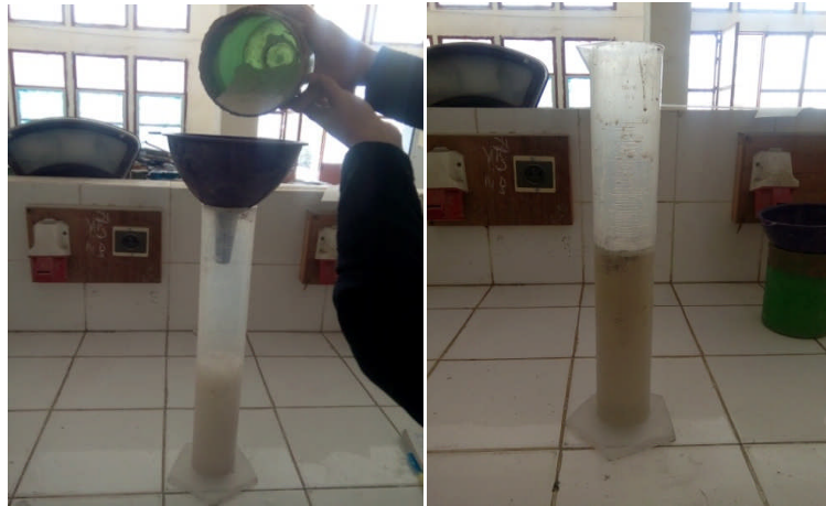
Figure III-8 : Essai de la détermination de la masse volumique absolue de la poudre de marbre.
