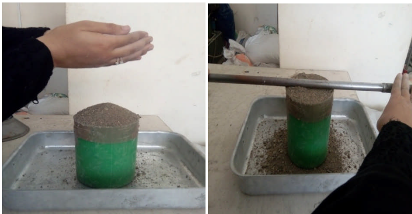
Figure III-7 : Essai de détermination de la masse volumique apparente du sable.
