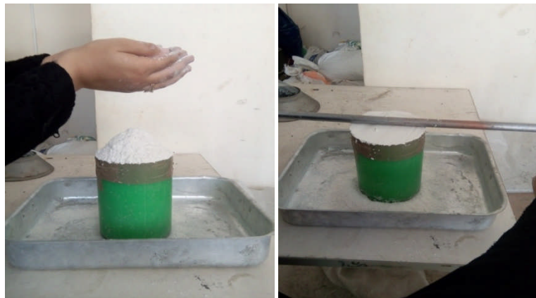
Figure III-9 : Essai de détermination de la masse volumique apparente de la poudre de marbre.
