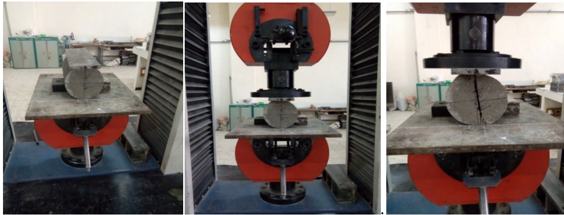
Figure III-28 : (a) :Eprouvette soumise à la traction par fondage. ; (b) :Eprouvette après rupture.
