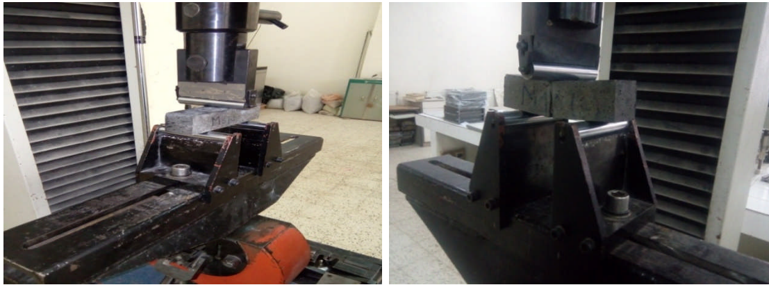
Figure III-26 : (a) : Epreuve soumise à la ; (b) : Epreuve après rupture. traction par flexion trois points.
