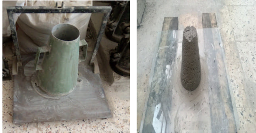
Figure III-22: (a): cône d'Abrams ; (b): Essai d'affaissement
