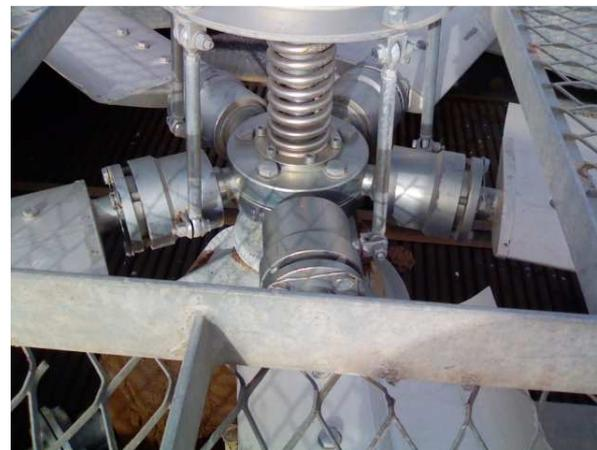
Figure 2.10 : Aperçu sur le mécanisme qui fait varier l' angle des pales
