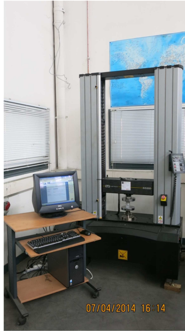
Figure II.6 : Machine universelle de traction-compression utilisée pour les tests quasi-statiques.
