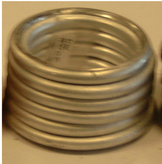
Figure I.9 : Mode de déformation axisymétrique obtenu sur un tube en aluminium, par écrasement axial quasi-statique (Baleh et al., [2003]).
