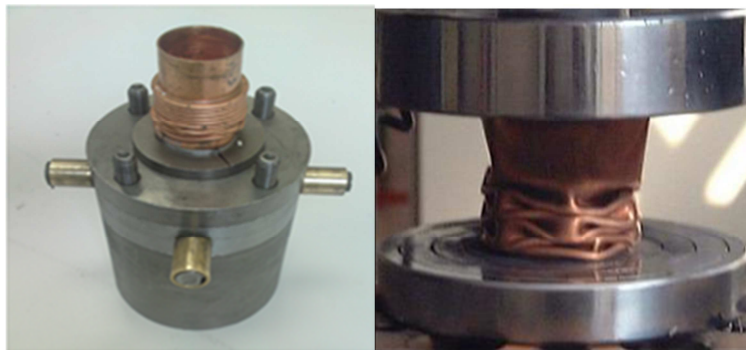
Figure IV.8 : Aperçu d'échantillons en fin d'écrasement pour deux configurations de flambage : biaxiale et uniaxiale de référence dite Uni L-L.
