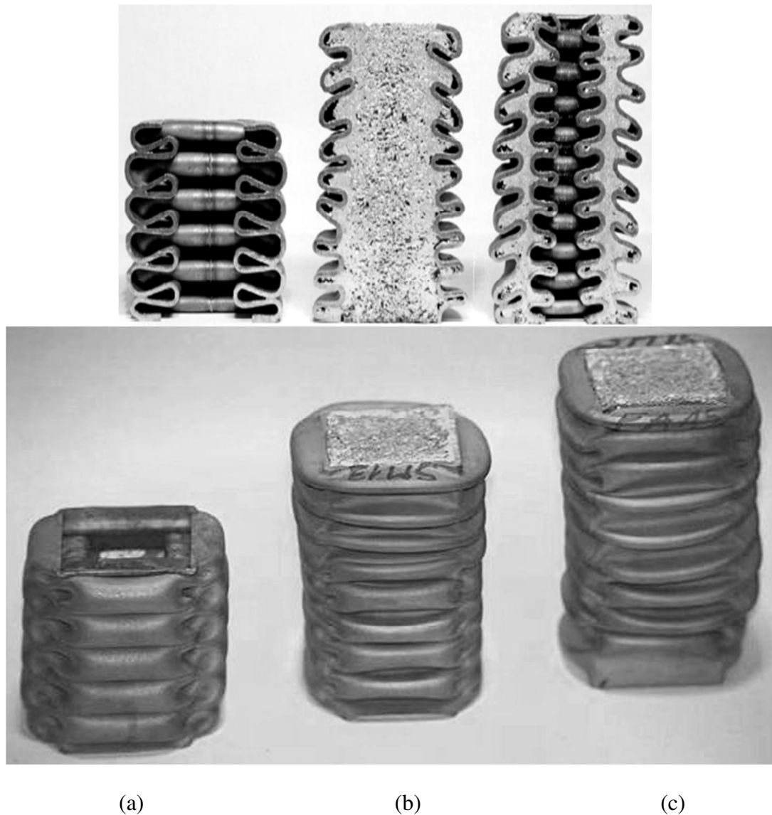
Figure I.25 : Mécanisme de flambage compact sur des structures en acier : monotubulaire vide (a) monotubulaire bourrée de mousse (b) et bitubulaire (c) bourrées de mousse d'aluminium (Seitzberger et al., [2000]).
