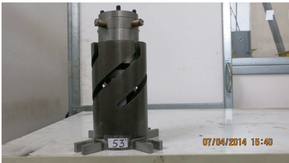
Figure IV.2 : Aperçu de la méthode expérimentale d'évaluation du frottement : spécimen écrasé en présence du frottement.
