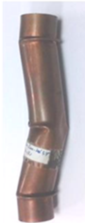
Figure I.8 : Mode de déformation eulérien obtenu sur un tube en cuivre, par écrasement axial quasi-statique (Baleh et al., [2003]).
