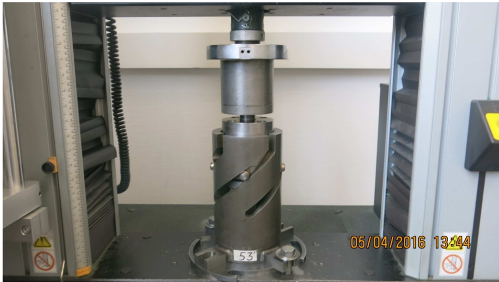
Figure IV.7 : Aperçu d'un test sur un échantillon en cours de flambage pour une configuration complexe sévère Bi-53°.
