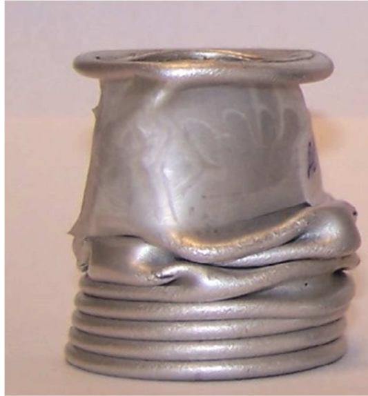
Figure I.11 : Mode de déformation mixte (concertina-diamant) obtenu sur tube en aluminium, par écrasement axial quasi-statique (Baleh et al., [2003]).
