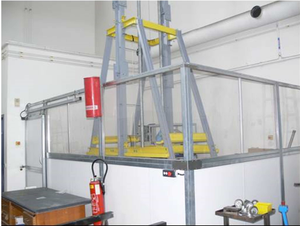
Figure II.11 : Vue d'ensemble de la station de crash-test : déclenchement des tests d'impact grâce à la console de commande extérieure.
