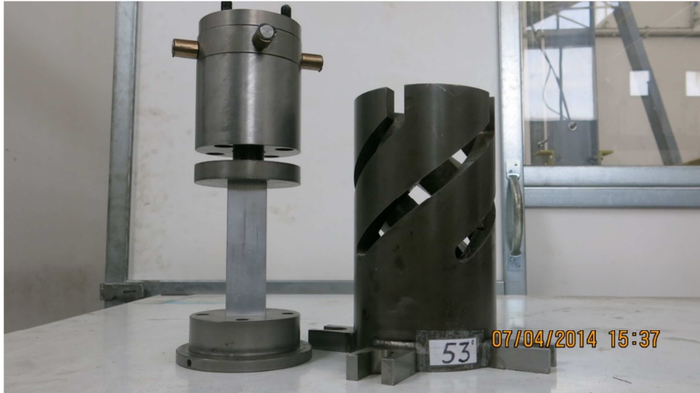
Figure IV.1 : Aperçu de la méthode expérimentale d'évaluation du frottement : spécimen écrasé sans frottement.
