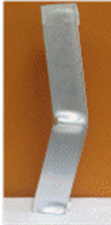
Figure III.2 : Exemple typique de mode eulérien (ME) d'une structure carrée sous un chargement uni axial libre-libre.
