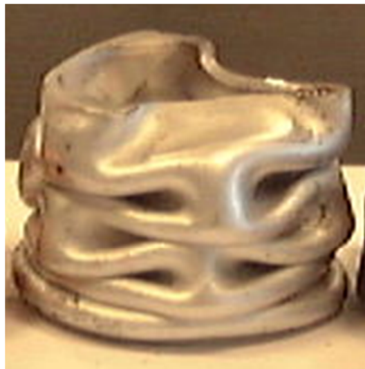
Figure I.10 : Mode de déformation non-axisymétrique (ou diamant) obtenu sur tube en aluminium, par écrasement axial quasi-statique (Baleh et al., [2003]).
