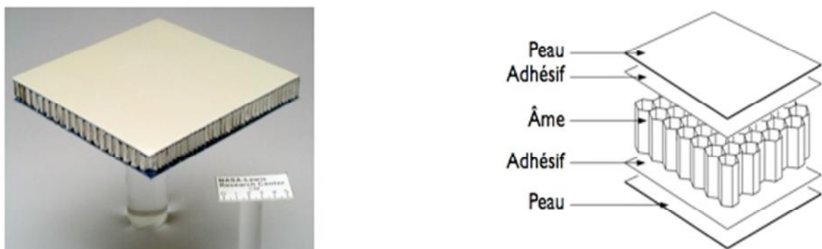
Figure I.18 : La forme d'un matériau sandwich.
