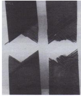
Figure III.13: Rupture d'un composite [\pm 45^\circ]_{2S} à fibres de carbone
