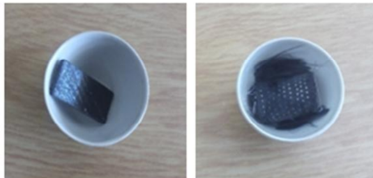
Figure IV.7: Echantillon avant et après calcination.
