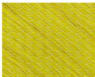
**Figure I.3** : fibre de d'aramide
