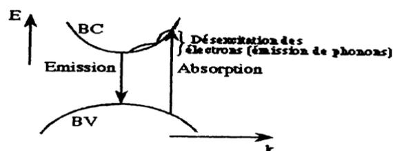
Figure (I- 24) : Transitions optiques entre la bande de valence et la bande de conduction [16].
