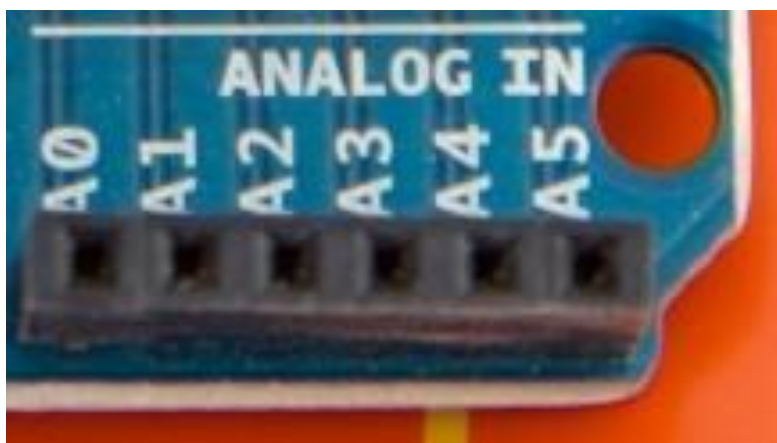
Figure III.12 entrées analogiques A0 à A5
