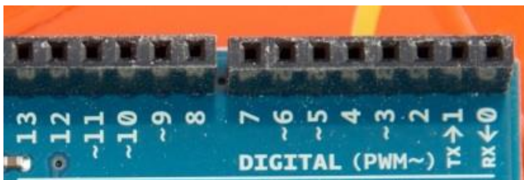
Figure III.11 Les entrées/sorties numériques D0 à D13
