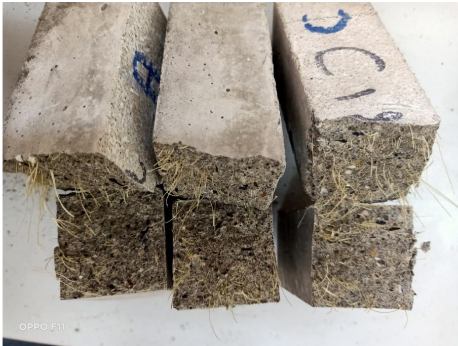
Figure IV.12 : Mode de rupture des éprouvettes avec fibres de Sisal.
