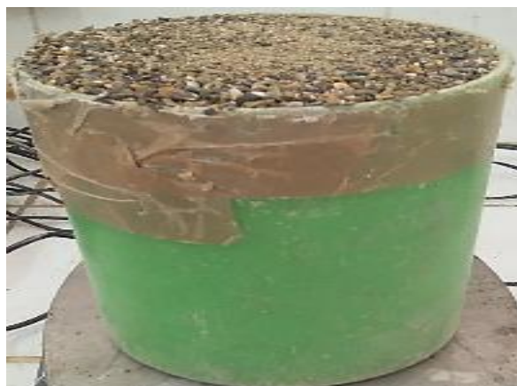
Figure III.7 : Mesure de la masse volumique apparente.
