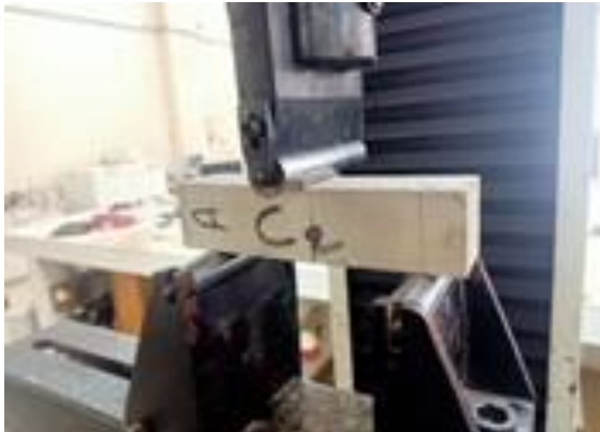
Figure IV.2 : Eprouvette sous traction par flexion trois points.
