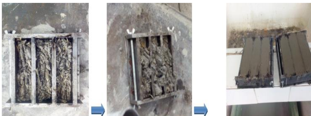
Figure III.9 : Fabrication et moulage des éprouvettes.
