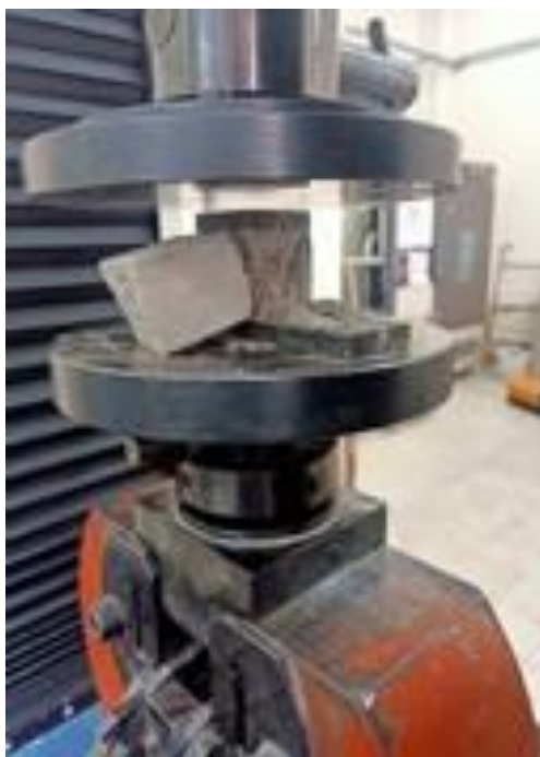
Figure IV.13: Eprouvette soumise à la compression.
