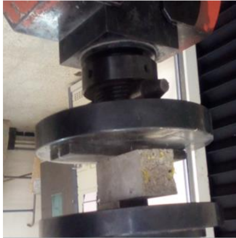
Figure III.12 : Dispositif de l'essai de compression.
