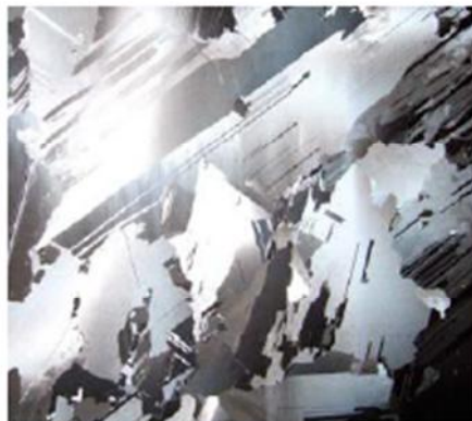
Figure I.10: image d'un substrat de silicium multicristallin [22]
