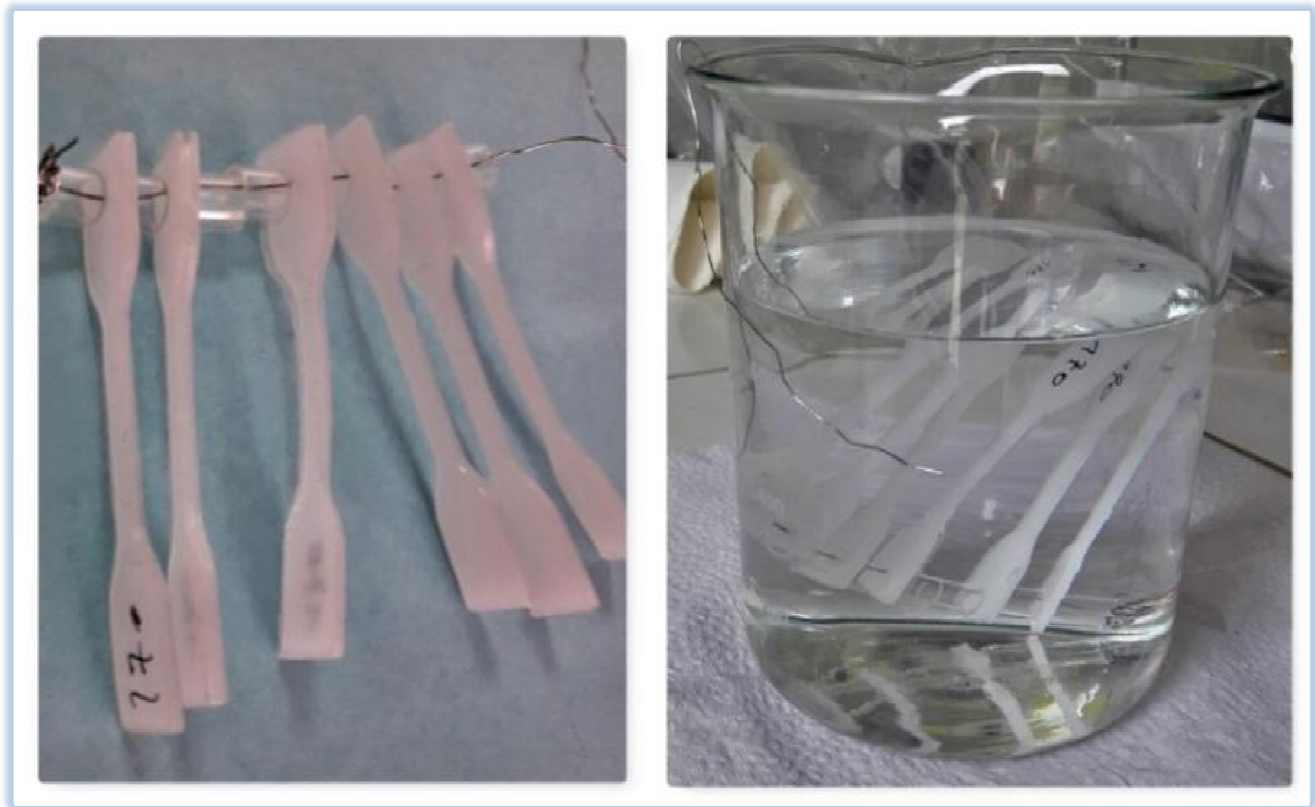
Figure.15 :Dispositif adopté pour l'essai d'absorption d'eau.
