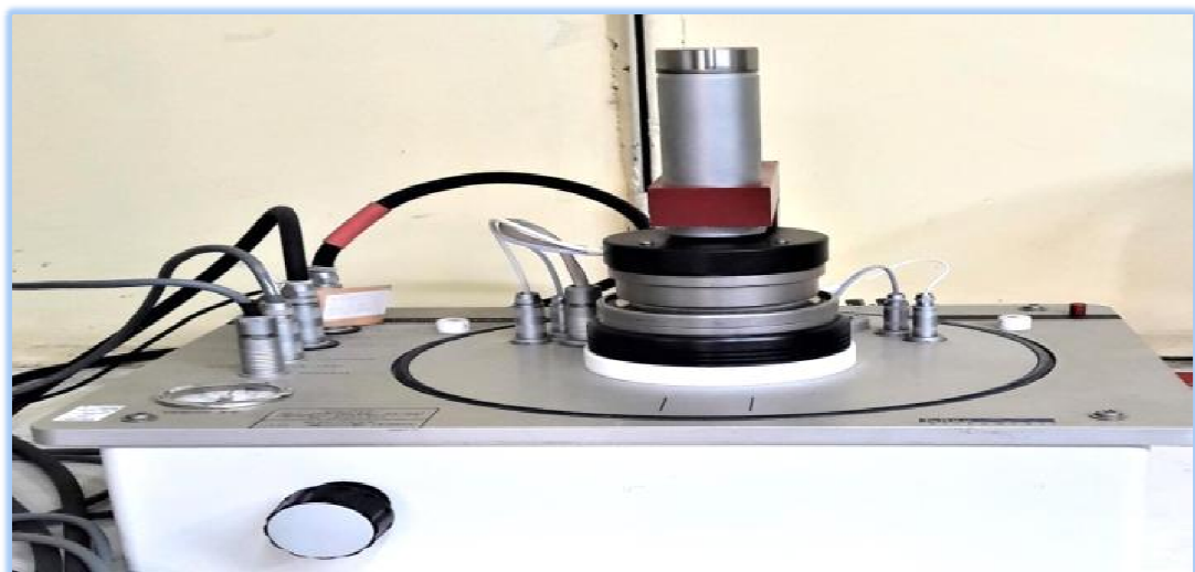
Figure. 22 : Dispositif de test diélectrique pour isolants solide.
