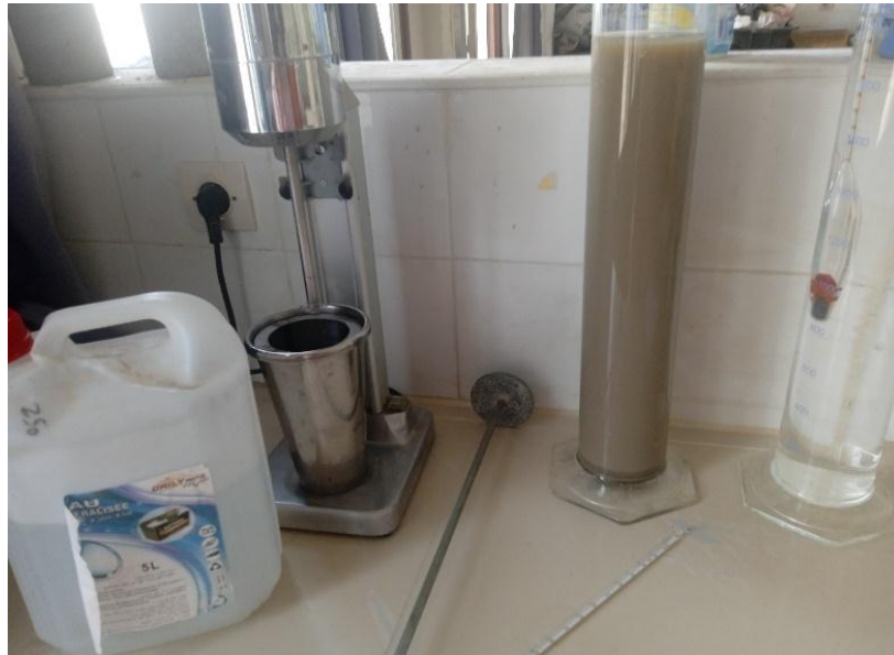
Figure IV.14. L'analyse granulométrique par sédimentation.
