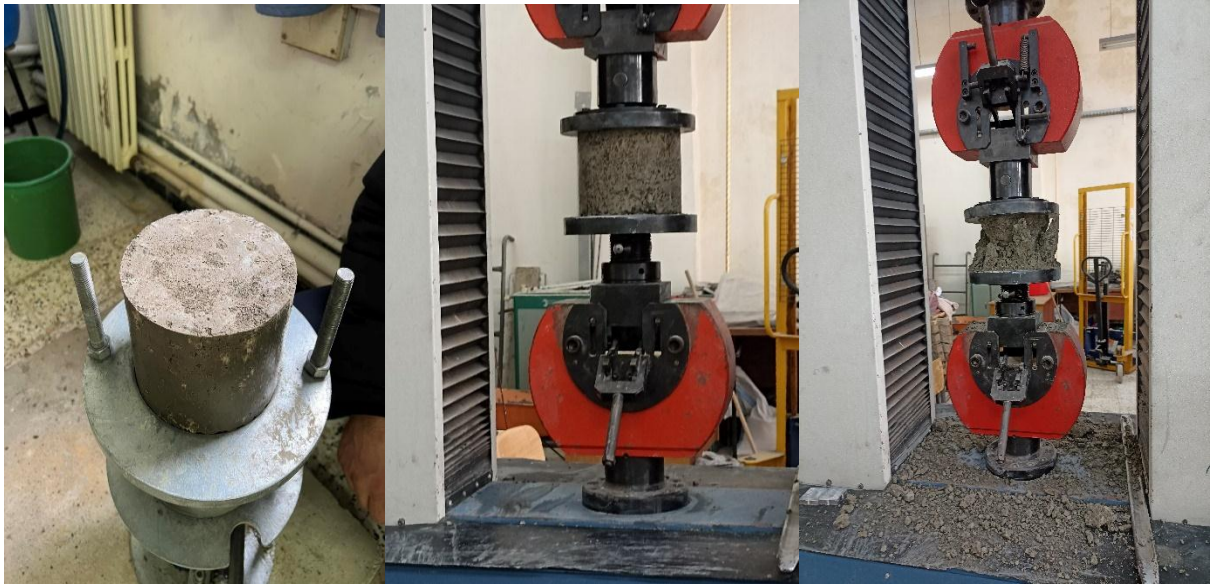
Figure V.65. Les étapes de l'essai de compression simple.
