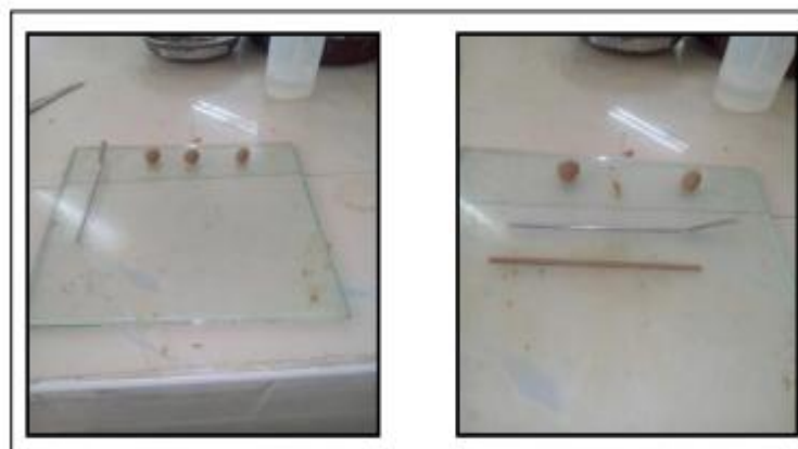
Figure IV.10. Détermination de la limite de plasticité.
