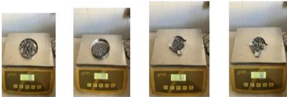
Figure IV.5. L'échantillon sec après séchage dans l'étuve.
