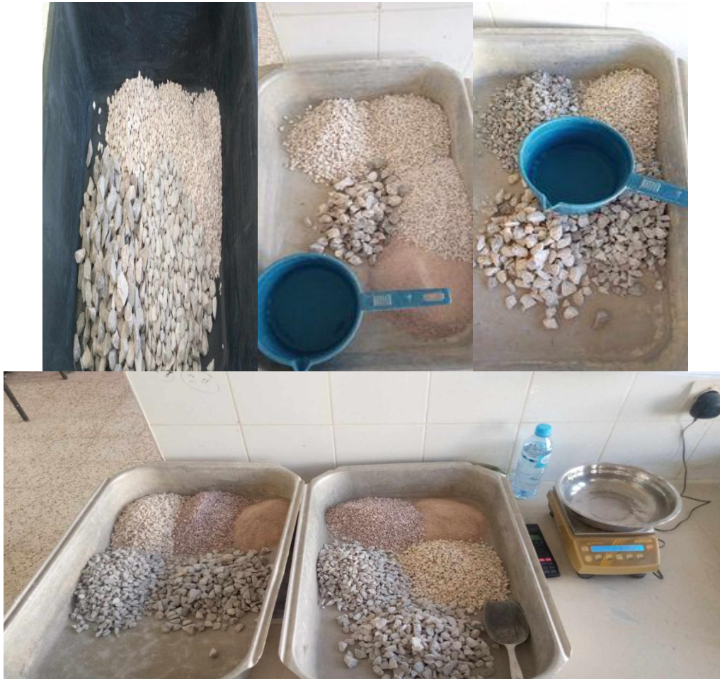
Figure V.8. Les mélanges de granulats pour l'essai Proctor modifié au Laboratoire MDS de l'UMMTO.
