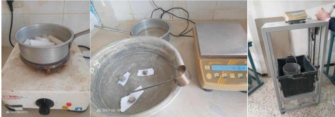
Figure IV.17. Mode opératoire de la pesée hydrostatique.
