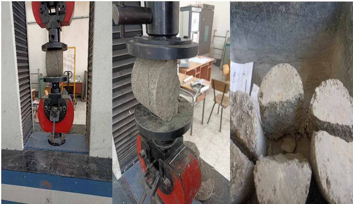
Figure V.78. Les étapes de l'essai de traction simple.
