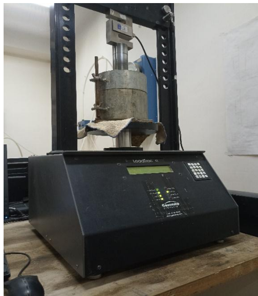
Figure V.12. La machine de poinçonnement Load Trac II (LGEA).
