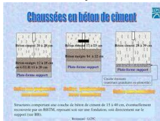
Figure I.7. Structure d'une chaussée en béton de ciment.
