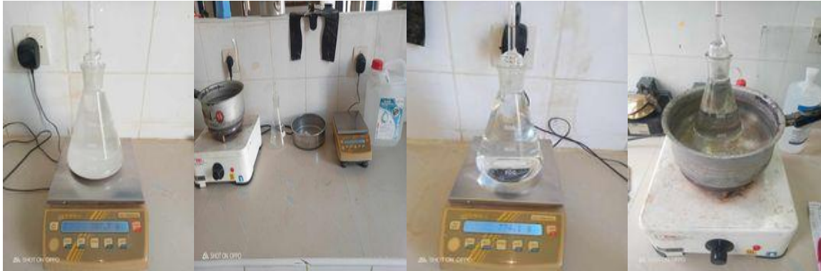
Figure IV.18. Mode opératoire de l'essai au pycnomètre.
