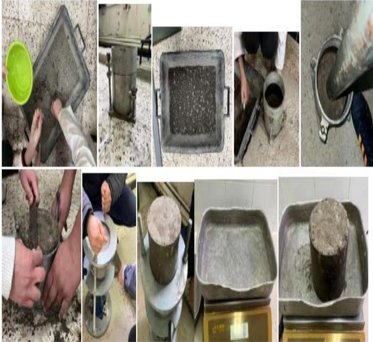
Figure V.7. Les images illustrant le déroulement de l'essai Proctor modifié sur le matériau argileux au Laboratoire MDS de l'UMMTO.
