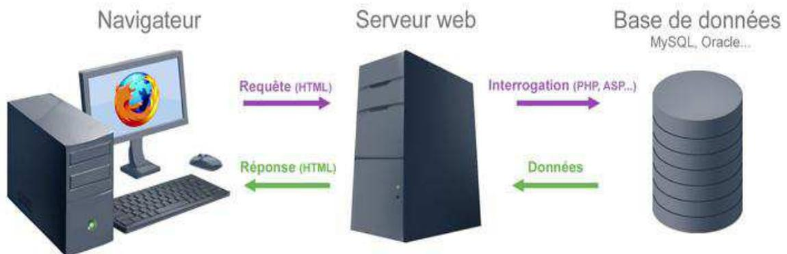
Figure I.3.3 : fonctionnement d'un site dynamique
