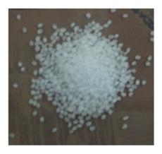
Figure IV.2: Grains de polypropylène utilisé pour l'injection
