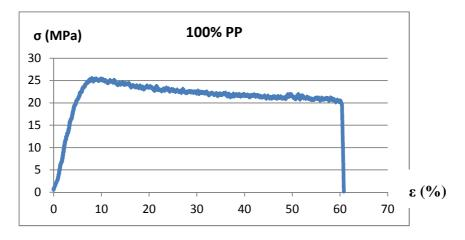
Figure V.1 la courbe contrainte déformation pour l'échantillon 100% PP
