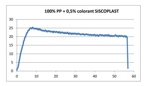
Figure V.4 la courbe contrainte déformation pour 100% PP plus 0,5% de colorant
