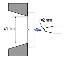
Figure IV 11 : position d'éprouvette et mouton-pendule
