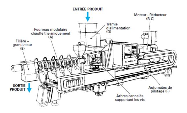
Figure I.3 : Machine à extrusion
