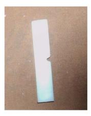
Figure IV.9 : éprouvette de résilience
