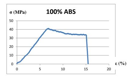
Figure V.10 la courbe contrainte déformation pour le mélange 100% ABS
