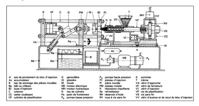
Figure I.2 : presse à injection plastique
