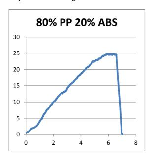
Figure V.9 la courbe contrainte déformation pour le mélange 80%PP plus 20% ABS
