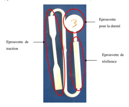
Figure IV.6 : Eprouvette élaborée par injection
