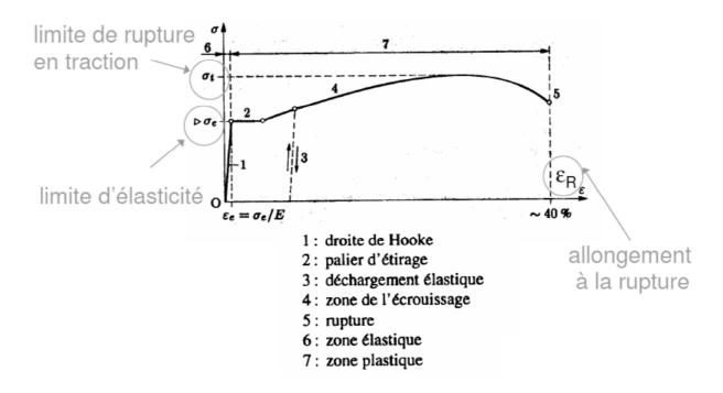
Figure V.11: courbe de traction analytique
