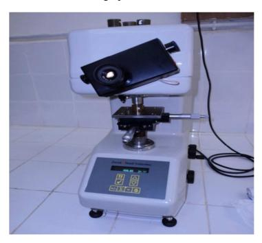
Figure IV.7: microduromètre
