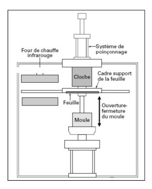
Figure I.4: Thermoformage
