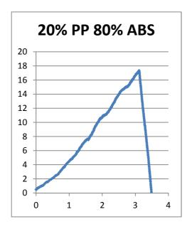
Figure V.5 la courbe contrainte déformation pour le mélange 20%PP plus 80% ABS
