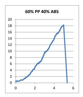
Figure V.8 la courbe contrainte déformation pour le mélange 60%PP plus 40% ABS
