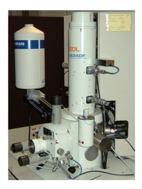
Figure IV.14 : Microscope électronique a Balayage
