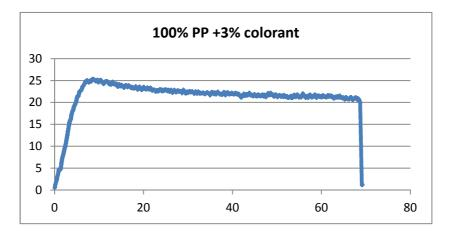
Figure V.3 la courbe contrainte déformation pour 100% PP plus 3% de colorant
