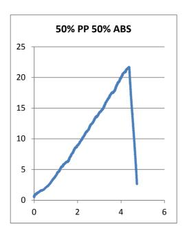
Figure V.7 la courbe contrainte déformation pour le mélange 50%PP plus 50% ABS
