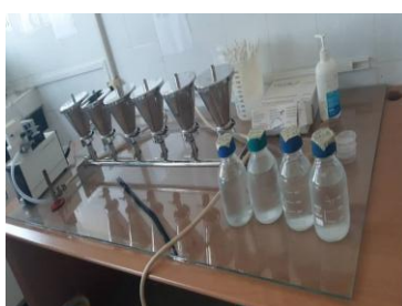
Ph11 : Rampe de filtration et pompe à vider
