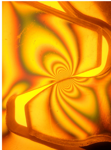
Figure IV.28 : Isochromes relevées expérimentalement
