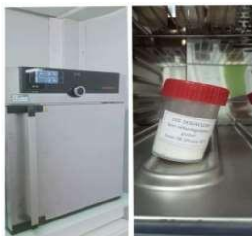
Figure 14: Échantillon du soin séborégulateur mis à l'étuve Memmert UF55 .
