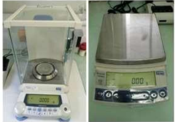
Balances analytiques : à gauche (balance analytique SHIMADZU AUV 320 ), et à droite (balance électronique SHIMADZU AUW2200H )
