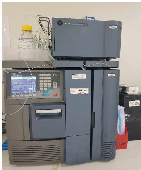
Système d'HPLC couplé à un spectromètre UV/visible (Waters Alliance 2695)
