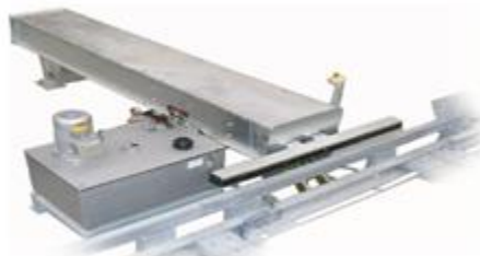
Figure II.3 : Poste de déchargement
