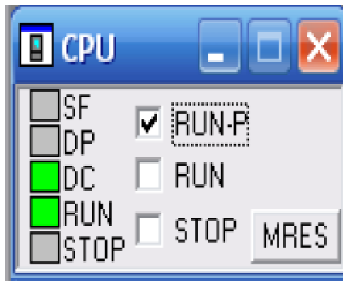
Figure IV.12 : Sélection de mode de la CPU.
