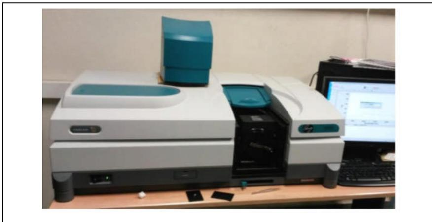
Figure II.6.Spectromètre UV-Vis Cary 5000
