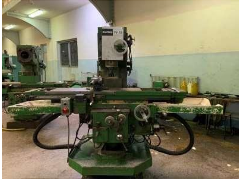
Fig.II.1.16 : Fraiseuse Verticale FV1, 5 ALMO.
