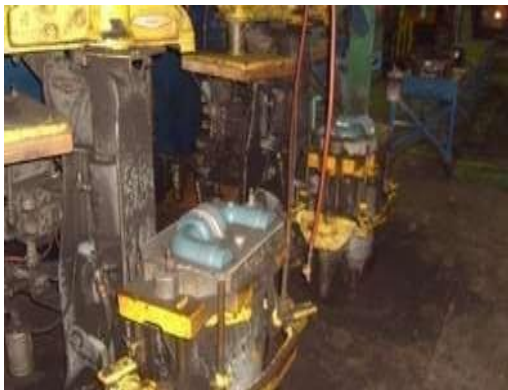
Fig.II.1.8 : Poste Pour Le Moulage En Sable
