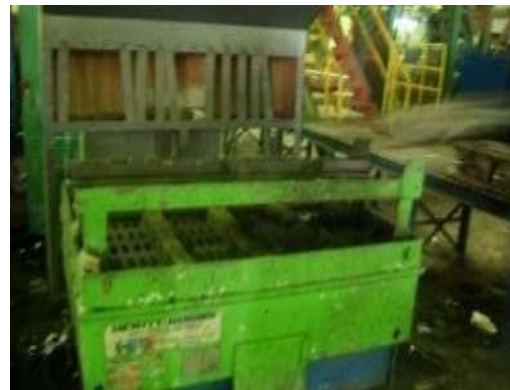
Fig.II.1.9 : Poste De Démoulage
