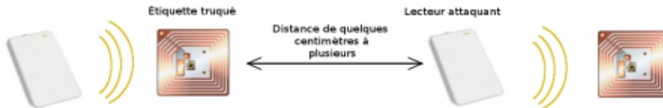
Figure II.3 : Schéma d'une attaque par relais
