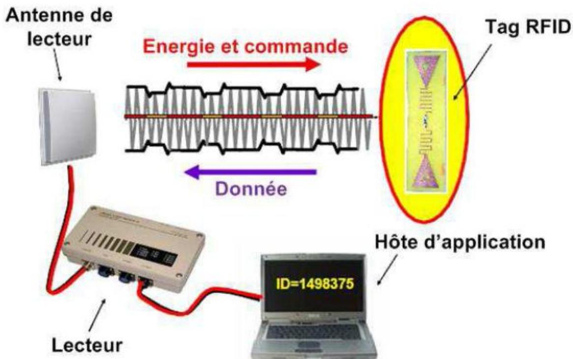
Figure I.2 : Eléments d'un système RFID [2]
