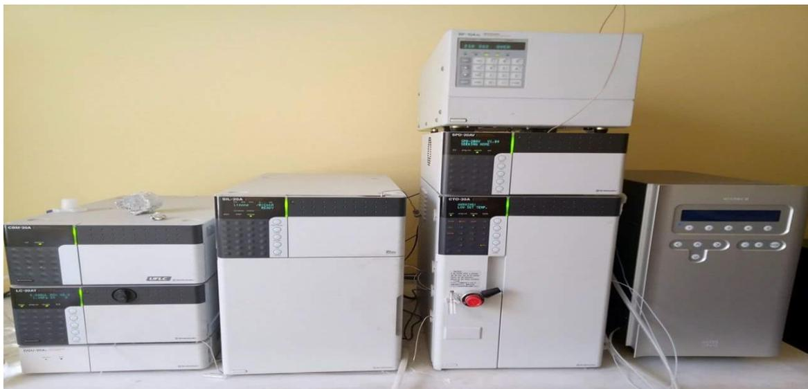
Figure 41 : Les organes d'une chaîne HPLC (Laboratoire de biochimie. Département de pharmacie de l'UMMTO)
