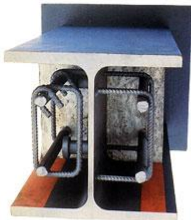
Fig. 1-9 Exemple de poteau mixte partiellement enrobée nécessitant généralement une protection à l'incendie.
