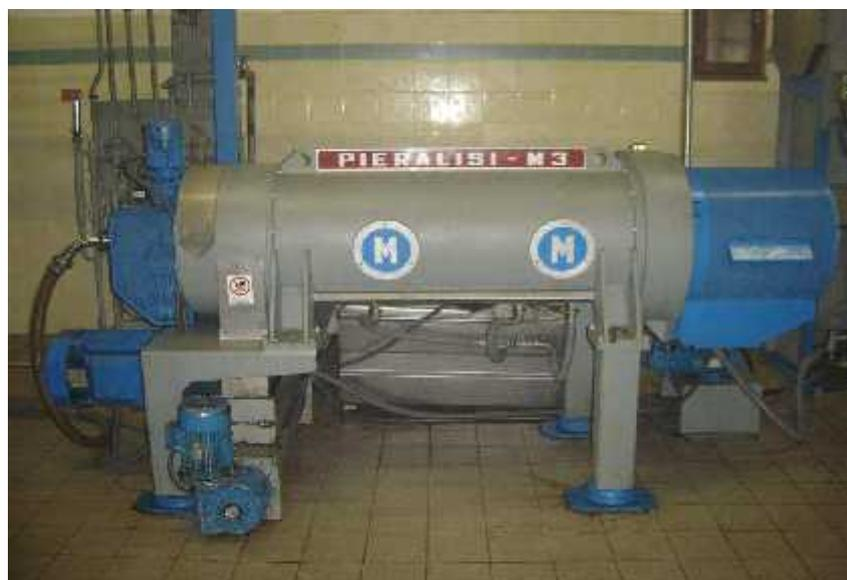
**Figure 20 :** Centrifugeuse horizontale
