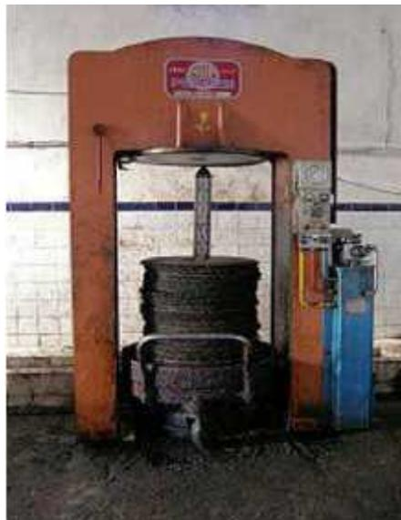
**Figure 19:** Presse hydraulique.
