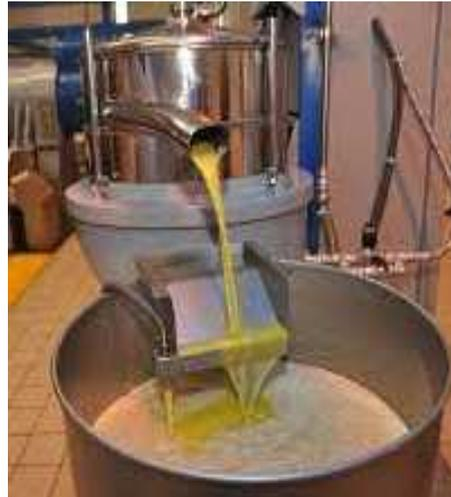
**Figure 22** : centrifugeuse verticale.
