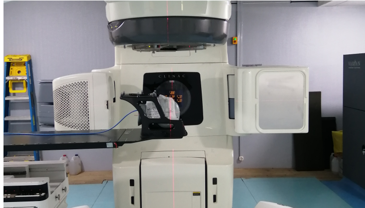
Figure 2.16 – Mesure de la dose ponctuelle avec la chambre PinPoint.
