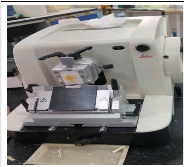
Figure 18: réalisation de coupes par microtome LEICA. Figure 19 : bain marie à 41c° (originale 2023)
