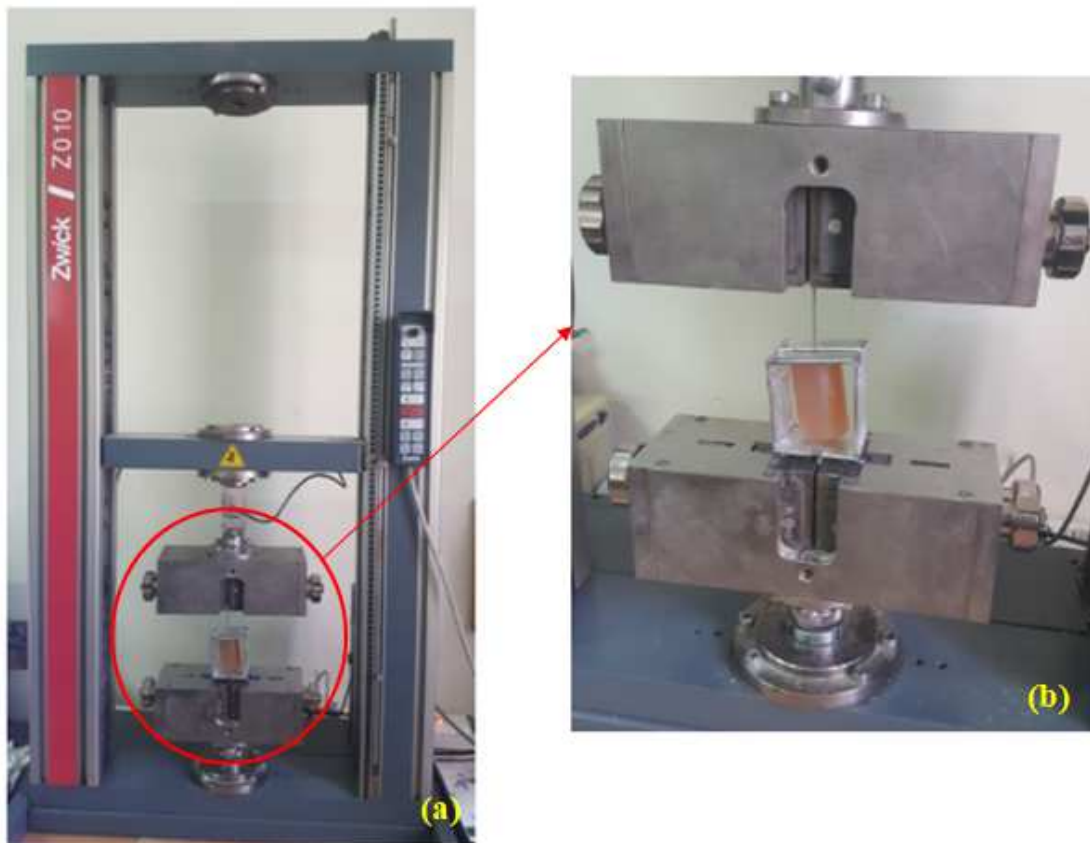
Figure IV.8: a) Machine de traction Zwick Roel Z010, b) Mors de traction utilisé
