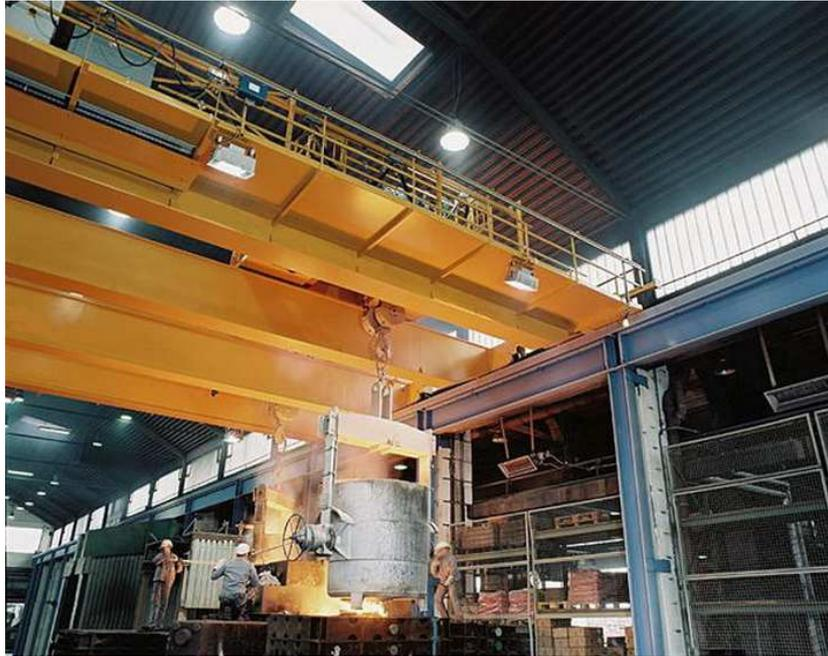
**Figure (I.7) :** grue de fonderie de type pont roulants
