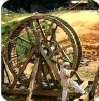
**Figure (I.4) :** photo d'une grue à cage d'écureuil
