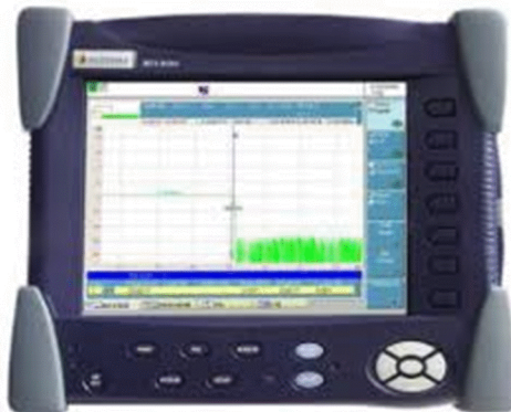
Figure 13: réflectomètre et sa réponse impulsionnelle
