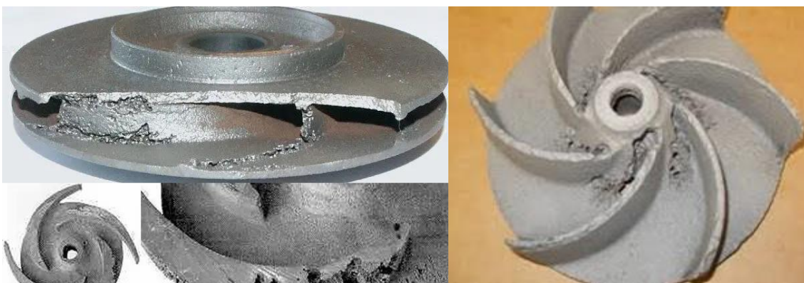
Figure V.8 : Le phénomène de la cavitation.
