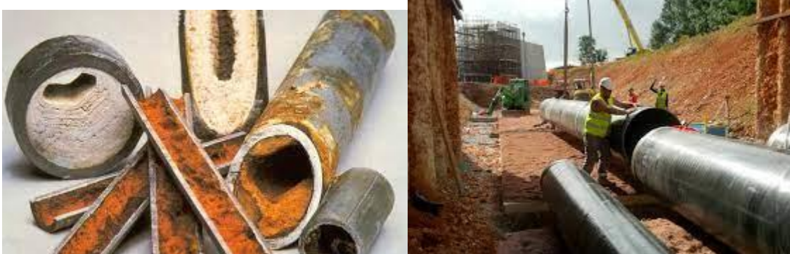
Figure IV.4 : les conduites en acier
