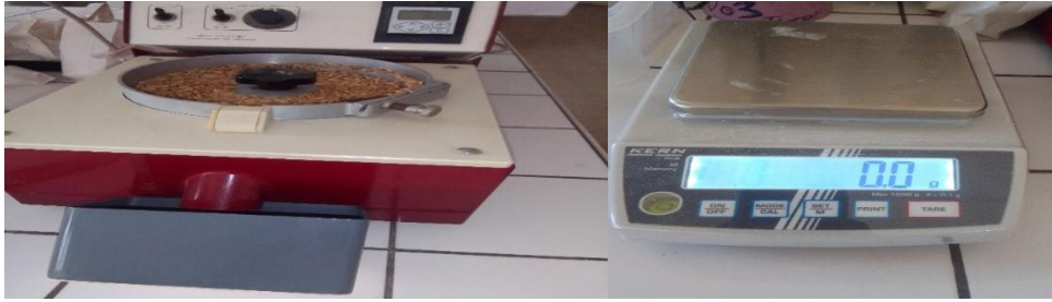
Figure15. Le compteur à grains de type NUMEGRAL et la balance analytique type KENR précise a 0.01 gramme.
