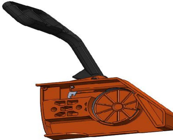
Figure II.62: Le système de freinage
