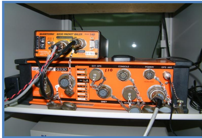
Figure-9 : Numériseur du signal sismique Q330
