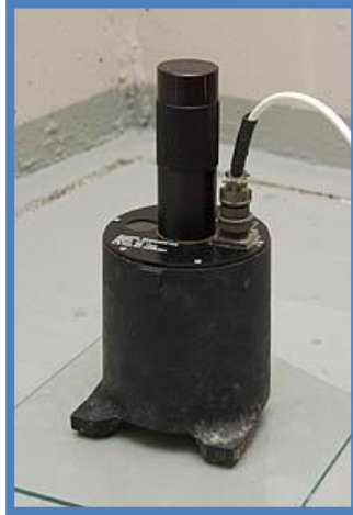
Figure-8 : sismomètre courte période SS-1
