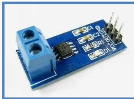
Figure-21 : Capteur de courant ACS712
