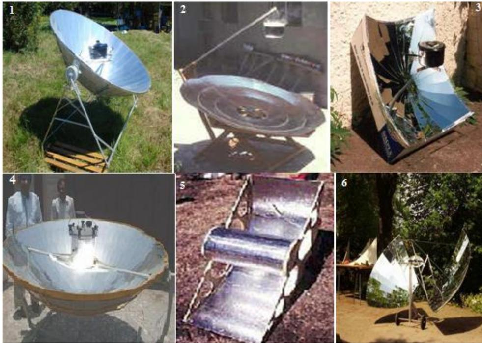
**Figure I-2 : Cuiseur solaire à concentration** : 1- parabolique, 2- parabolique orienté vers le haut, 3- forme carrée concave, 4- sphérique, 5- cylindro-parabolique, 6- à parois réfléchissantes en forme d'aile.
