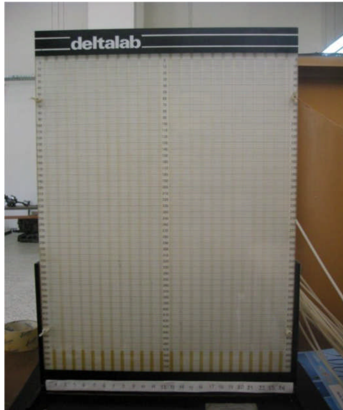
Figure (II-15) : Multi-manomètre du laboratoire.
