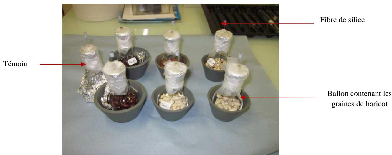
**Figure 36.** Dispositif expérimental de la méthode de microextraction en phase solide (SPME) des substances volatiles des cinq cultivars de haricot et du lot témoin
