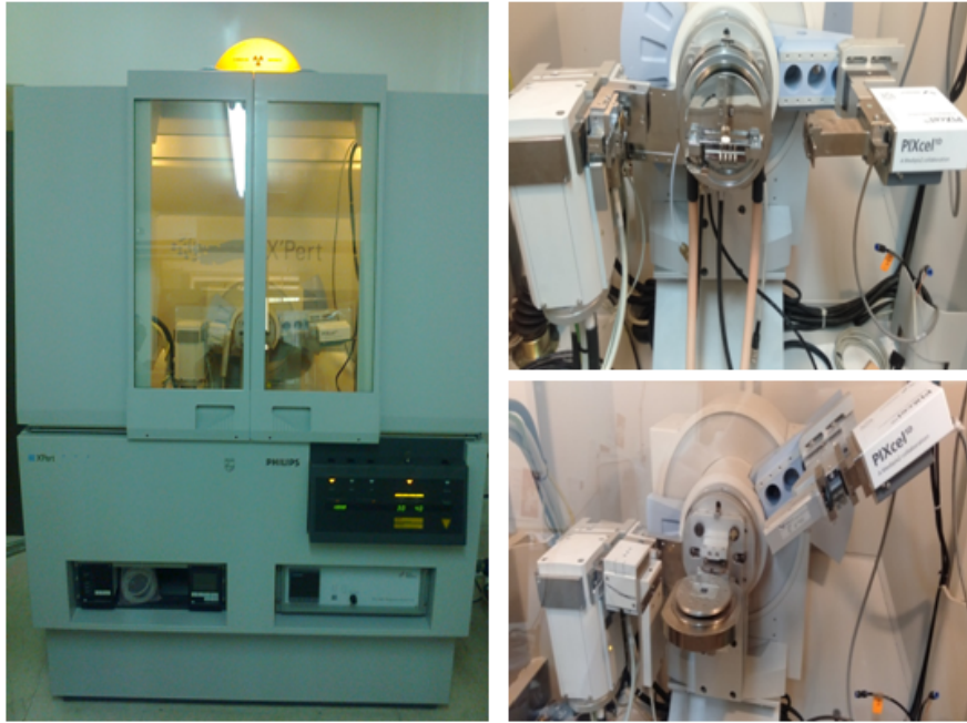
FIGURE 2.3 – Diffractomètre « X'PERT PRO MPD » de Philips installé au CRNB.
