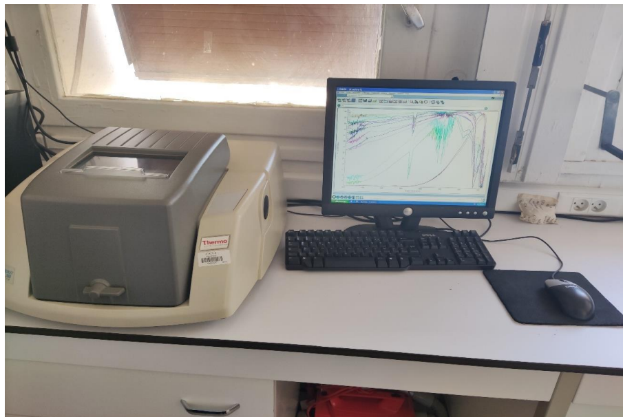
FIGURE 2.6 – Photographie du spectromètre infrarouge type Nicolet 380.
