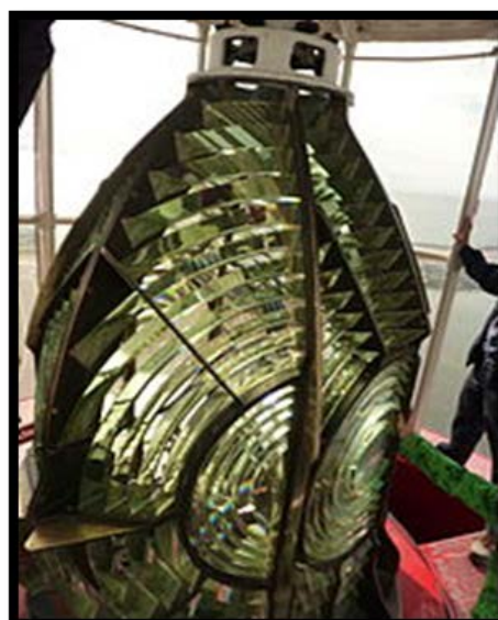
La lentille de Fresnel dans la coupole du phare Source: http://www.wikimedia.org
