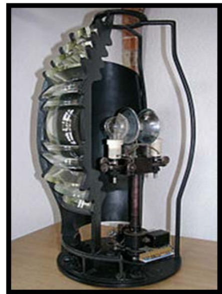
Vue éclatée d'une optique avec lentilles de Fresnel Source: les phares des cotes de France du XVI au XX siecle.pdf
