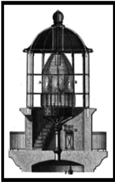
Lanterne de phare, contenant un système optique à lentilles de Fresnel
